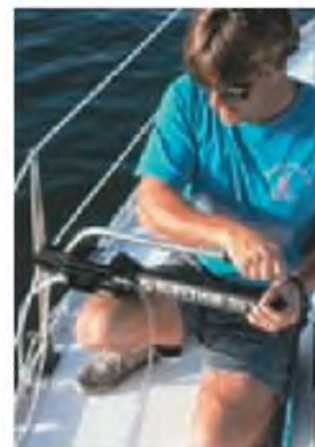
▲ Figura 18.17 Un dispositivo desalinizador portátil. Este desalinizador de agua operado manualmente funciona por ósmosis inversa; puede producir 4.5 L (1.2 gal) de agua pura del agua de mar en una hora.
